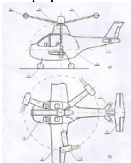
Фиг.5 Однороторный СВВП с РД на концах лопастей
